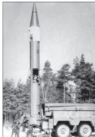
Systém Temp-S připraven k odpálení rakety
